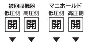
⑥ マニホールドの低圧側が所定の圧力(下表)に達したら、被回収機器とマニホールドの低圧側・高圧側を **閉**
