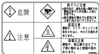
①排ガス・高温・高電圧
