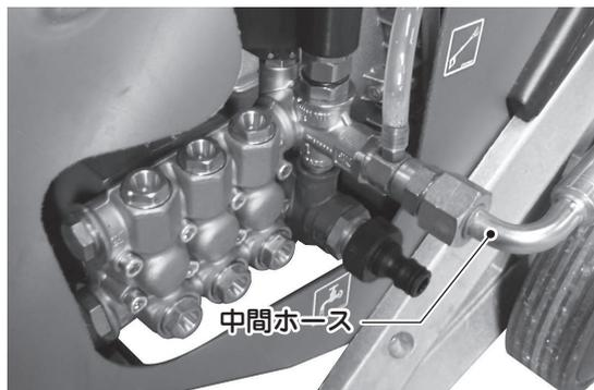
② 標準付属品の六角棒レンチ 4mm と六角棒レンチ 5mm を使用してカバーを外してください。
