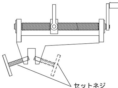
溶接する配管に接続する継手（または材料）を配置します。
