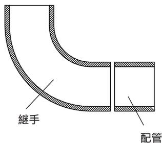
継手アジャスタ本体の取り付け溝に接続する継手の取付端面に近づけます。
