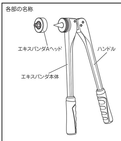
※エキスパンダAヘッドに刻印されているサイズは、冷凍機用銅管の外径を表しています。
