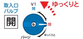
④ 液回収が終了し、ガス回収に変わったら、被回収機器とマニホールドの低圧側を **開**
