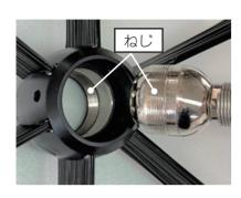
⑥ ④と同様に、フロントガイドとスプリングのねじ穴を合わせ、つまみねじを3か所 締め込み固定する。
