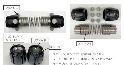
②フロントガイドのキャップを反時計回りに回して外す。スリットに、希望のサイズにカットしたブラシをスライドしながら奥まで入れる。6か所全て入れたらキャップを締める。リアガイドも同様にセットする。
