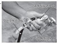
③パイプの端面に、本機のセットねじを使用して固定 します。
