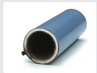
砥石切断機による切断パイプ見本
