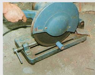
砥石切断機による切断風景
