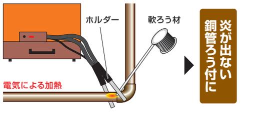
従来のバーナによる加熱作業では裸火による火災等の心配がりましたが、電気ろう付けによる加熱作業では裸火が出ないため火災等の心配が大幅に減少。
