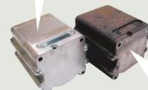
オイルを未交換で使用し続けて腐食したポンプユニット。修理の95%は、オイルを交換していないこの状態になって返却されています。
