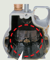
酸分やコンタミ類などによって激しく汚染されたオイル
