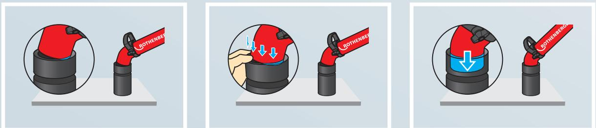
① アダプタを机の上など固定したものの上に置いて、赤い筒の先端の一部をゴムの内面に5~10mmほど入れます。
