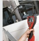
標準付属品のカメラケーブル1000に付け替えれば、配管・機器内、床下、天井など様々な作業に対応可能。
