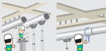
照明器具取付け用天井開口機の昇降装置・システム天井の取付けに
