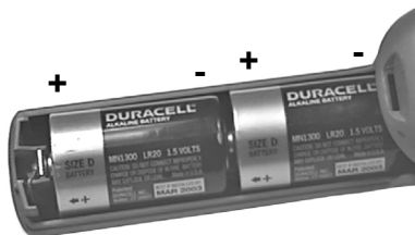
図1. 適切に取り付けられたアルカリバッテリー
